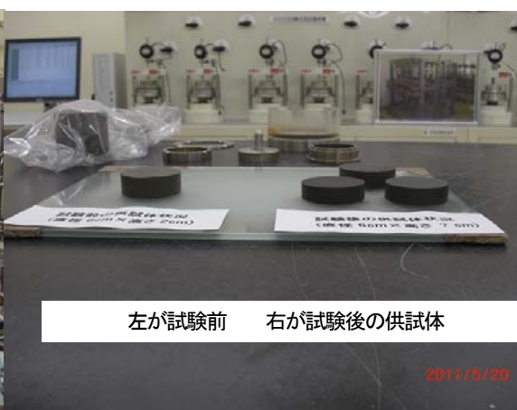
岩田暁作製による試験前後の圧密試験供試体の比較
