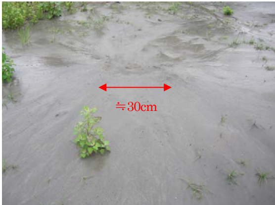
P-10 高洲9丁目で確認した噴砂の原型
