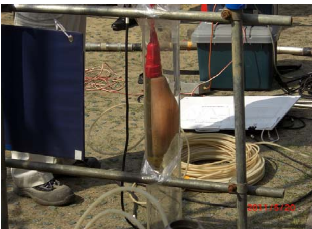
PS 検層 (板たたき方の孔内センサー部) (↑)
