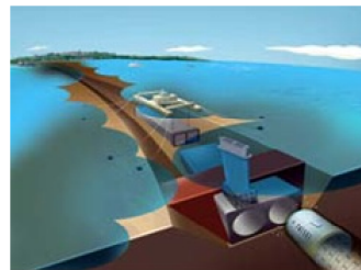
図-8 ボスポラス海峡横断トンネル 沈埋トンネルとTBMの接合部
